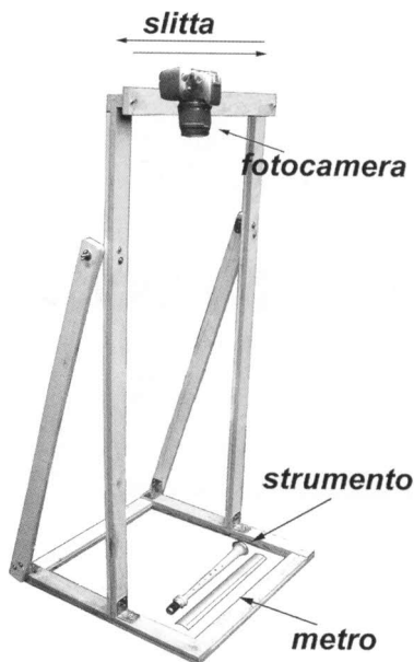
Esempio di cavalletto con slitta per la fotocamera
