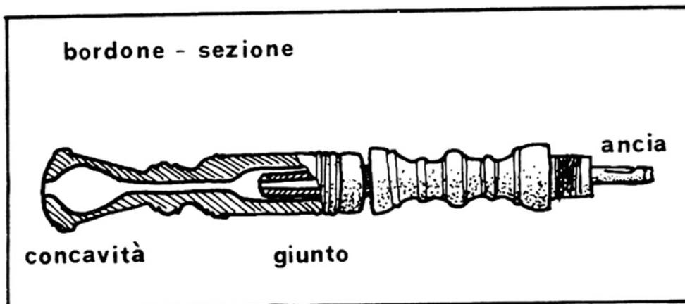
Il bordone maggiore è costituito da tre segmenti innestati telescopicamente. Emette la nota LA due ottave sotto la *diana*. Anche qui l'accordatura si ottiene aumentando o diminuendo la lunghezza totale. Il canneggio è sempre cilindrico e anche in questo caso termina con una concavità scavata all'interno, come nel caso del bordone minore. Lo stesso dicasi per il tipo di ancia montata.
